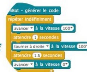
Les **instructions** d'un **algorithme** peuvent être déclenchées en **séquences** : les ordres étant enchainés les uns à la suite des autres sans conditions préalables (avancer, tourner...) et / ou **répétées en boucle** un nombre de fois précis, indéfiniment ou en fonction des événements détectés par les capteurs.
